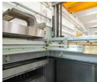
Clamp frame with automatic control Cornice premlastra con regolazione automatica
