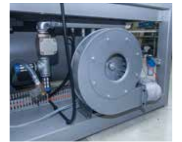
Electric fan for bubbling, vacuum and extraction Elettroventilatore per imbutitura, vuoto ed estrazione proporzionali
